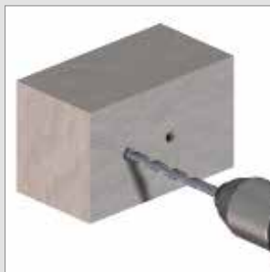
1. Löcher bohren
