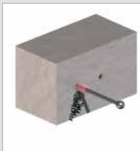
2. Löcher reinigen
