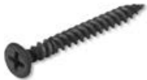
Bild 34 Knauf Diamantschraube XTN Schraubendurchmesser d_n : 3,9 mm Längen: 23/33/38/55 mm
