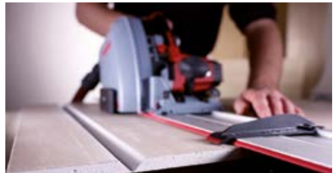
Bild 6 Knauf Platte falten und kleben (Foto: © Mafell AG)
