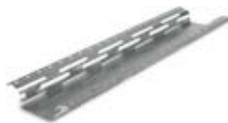
Bild 33 Federschiene 60x27 Befestigung an Sparren/Kehlbalken: 2x Knauf TN 3,5x35
