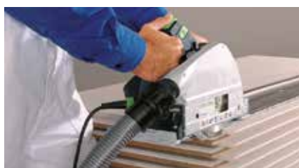
Bei Wandanschluss wird der obenliegende Falz abgeschnitten
