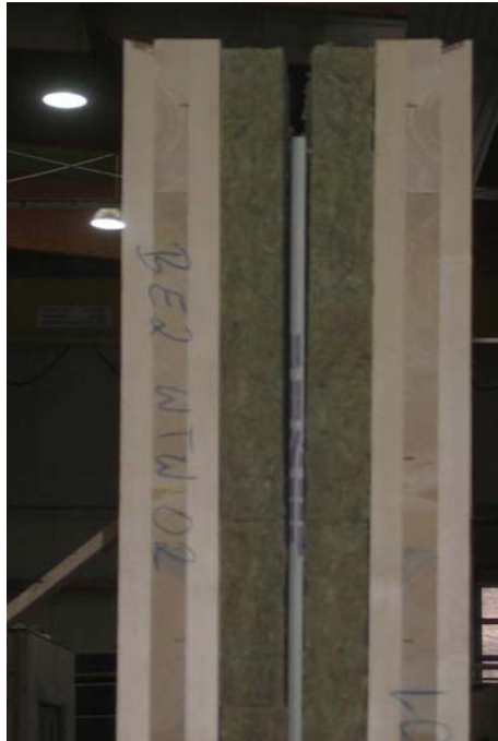
Abbildung 34: Zwischenraum der Trennwand mit Mineralwolle ausgefüllt (Gipskartonplatte aus schallschutztechnischen Gründen)
