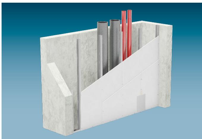
Das Schachtwandsystem **W628B.at** wird mit Einfachständerwerk mit Einfachprofilen ausgeführt.
